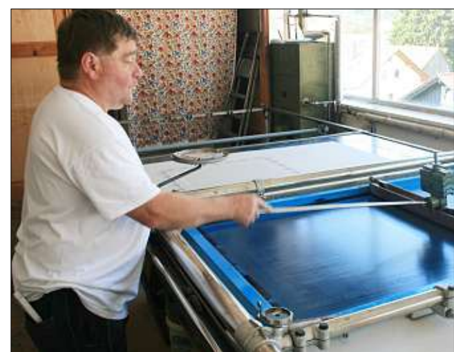
Willi Preiß demonstriert das Siebdruckverfahren und verteilt Farbe über einer Schablone.
